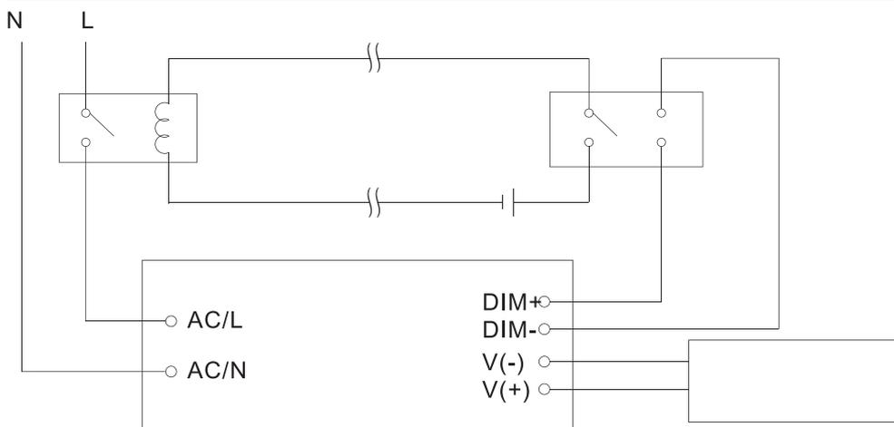
mit Hilfe eines Schalters und eines Relais können Sie die Beleuchtungseinrichtung ein- und ausschalten.
